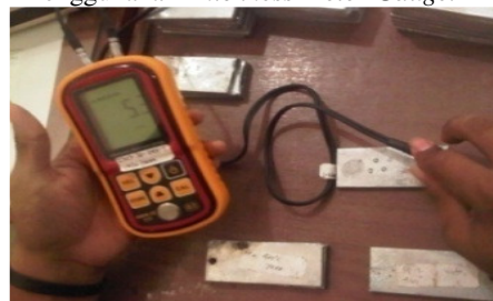
Gambar 8. Proses Pengujian Ketebalan Lapisan
