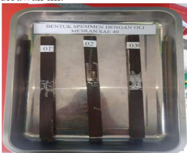
Gambar 3. Bentuk Spesimen Dengan Pendingin Oli Mesran SAE 40
