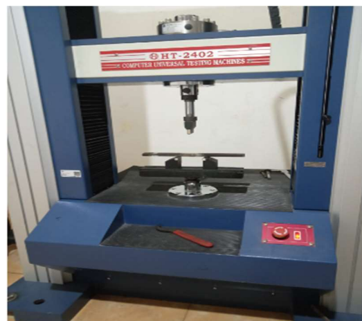
Gambar 8. Proses Pengujian Lengkung/Bending
