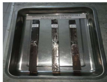
Gambar 6. Bentuk Spesimen Dengan Pendingin Oli Mesran SAE 20W-50
