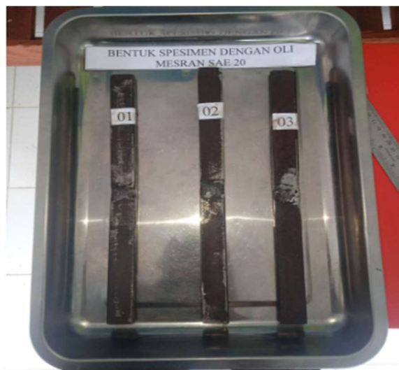
Gambar 2. Bentuk Specimen Dengan Pendingin Oli Mesran SAE 20
