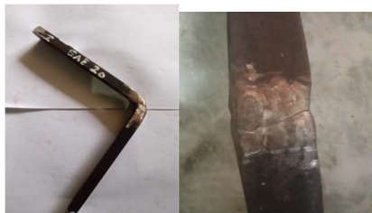
Gambar 13. Bentuk Spesimen Nomor 1 SAE 20 Setelah Pengujian
