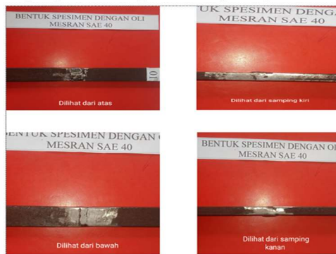
Gambar 5. Proses Pengamatan Bentuk Spesimen Nomor 1 Setelah Didinginkan Menggunakan Oli Mesran SAE 40
