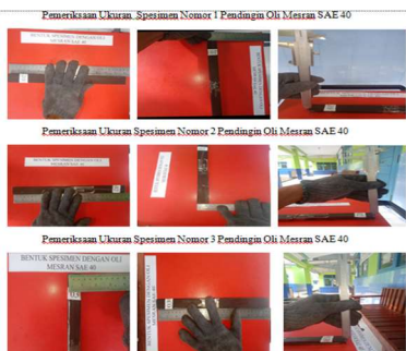
Gambar 4. Proses Pemeriksaan Ukuran Spesimen Didinginkan Menggunakan Oli Mesran SAE 40
