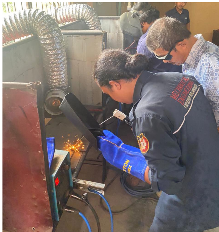
Gambar 7. Kaprodi Teknik Mesin Universitas Malahayati memperagakan cara pemasangan elektroda pada penjepit
