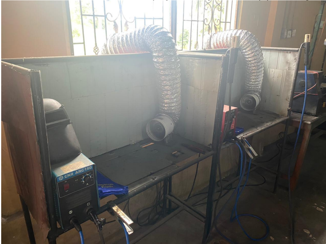
Gambar 4. Tempat kerja untuk pengelasan SMAW
