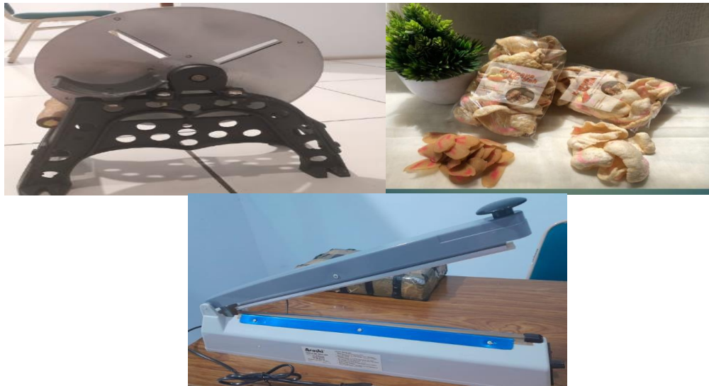
Gambar 6 : Alat potong kerupuk, Sealer perekat plastik dan perbaikan kemasan kerupuk yang lebih awet
