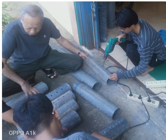
Gambar 3 Pembuatan perangkat pipa PVC 4 inci
