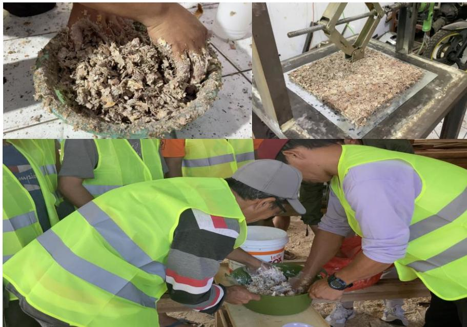
Gambar 7. Proses Transformasi Limbah Serutan Kayu dengan Cetakan Alat Press Hidrolik
