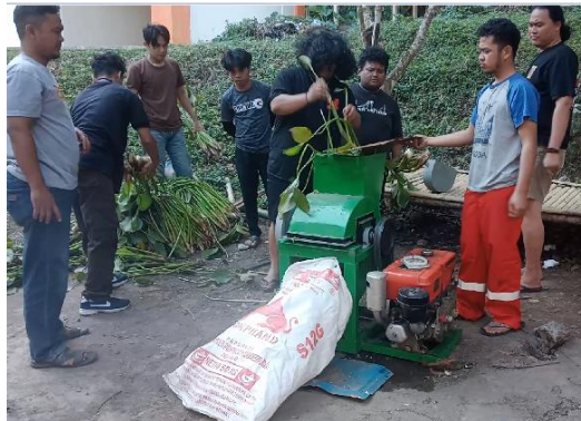
Gambar 8. Mesin Pencacah Eceng Gondok Dan Penerapannya
