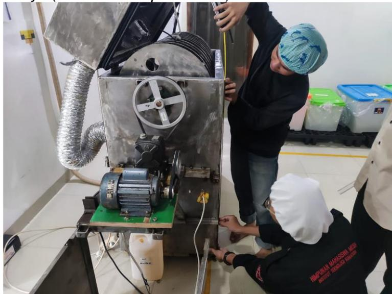
Gambar 5. Dokumentasi alat penurun kadar air madu.
