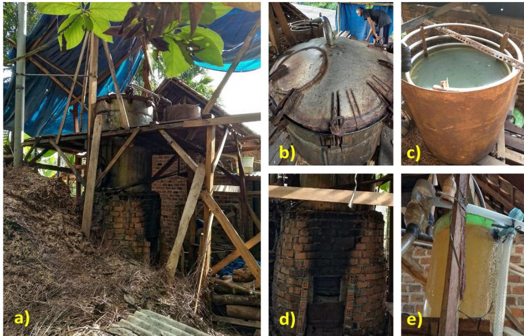
Gambar 1. a) Instalasi Destilasi Sistem Kukus, b) Ketel Utama Kapasitas 500 kg, c) Bak Pendingin, d) Tungku Api, e) Tangki Separator
