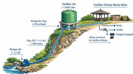
Gambar 5. Skema Sistem Penyediaan Air Bersih Menggunakan Kombinasi Pompa dan Gravitasi (Sumber: Peneliti, 2026)
