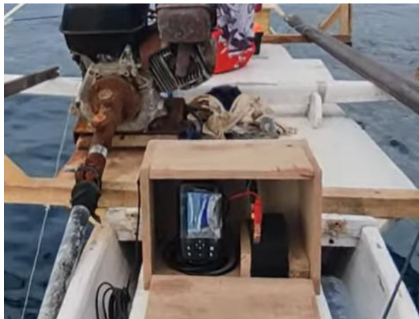
Gambar 6. Ujicoba pemasangan dan penggunaan fish finder di perahu anggota mitra
