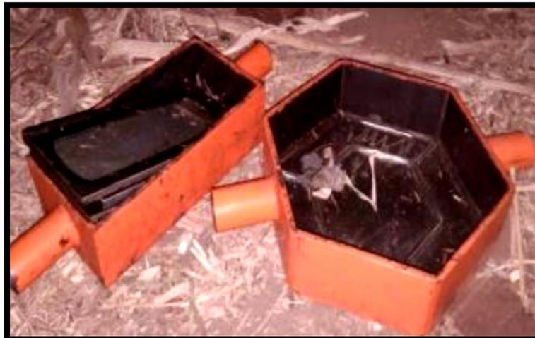
Gambar 6. Tempat percetakan untuk pembuatan paving block
