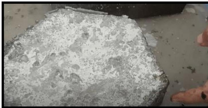
Gambar 7. Hasil paving block dari cetakan dengan merendamnya dalam air
