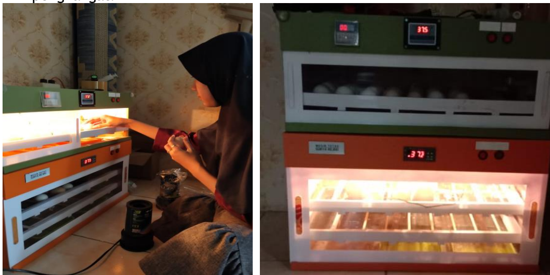
Gambar 4. Kegiatan memasukkan telur ke bok alat penetas telur otomatis
