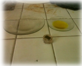
Gambar 6. Cairan etsa FeCl (5gr FeCl 3 , 50ml HCl dan 100gr H 2 O)[2].
