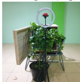
Gambar 6. Pengukuran Kebisingan dengan media tanaman Bouenville ( Bougenville sp. )
