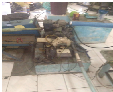
Gambar 2. Pengujian Emisi Gas Buang Pada Mesin Uji Emisi STARGAS 898
