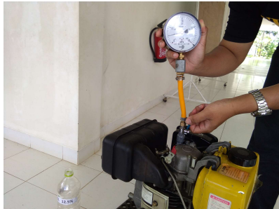
Gambar 3. Pengukuran Tekanan Pembakaran Pada Mesin Genset KW 20-388
