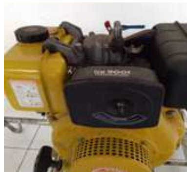
Gambar 1. Modifikasi Kepala Silinder Genset KW 20-388
