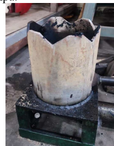
Gambar 7. Hasil Modifikasi Pada Bagian Tungku Lebur
