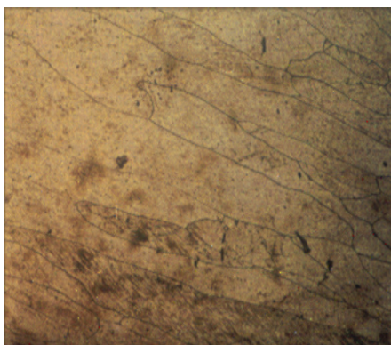
Gambar 6. Kode sampel A - 1. Cetakan logam tembaga 5 mm Pembesaran 108x
